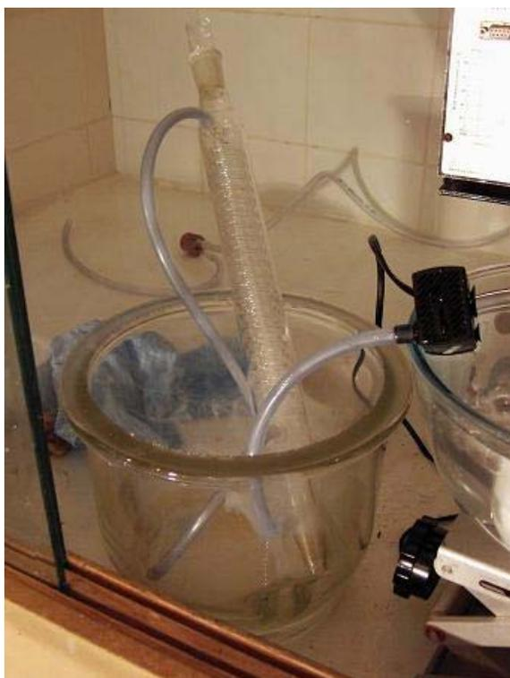
Муфель был выключен, установка разобрана. Конденсатор, который был свободен от аэрозоля на протяжении всей процедуры, после отсоединения от установки стал дымить (см. рисунок выше).
