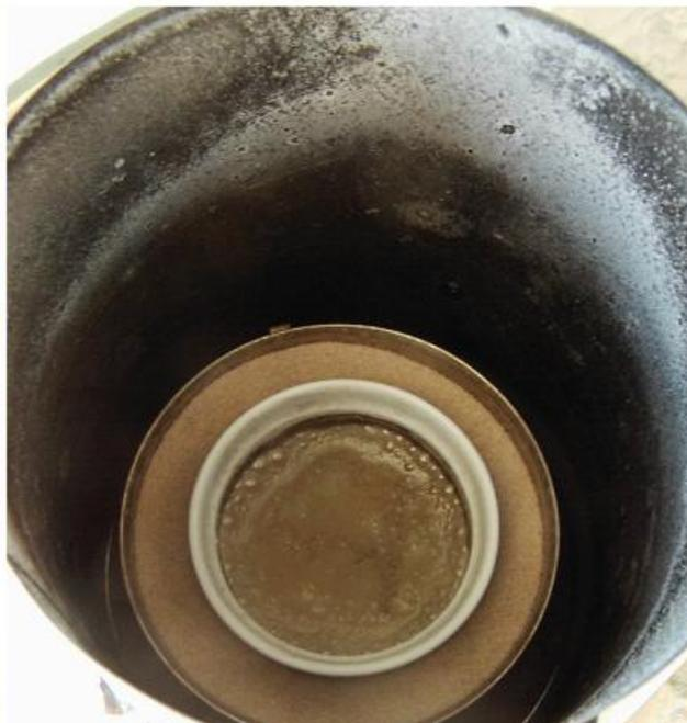
относительно постоянной примерно в течение часа. По-видимому, это объясняется испарением азеотропа  $\text{H}_2\text{SO}_4$ . Отгонка была прекращена, когда температура поверхности расплава достигла  $425^\circ\text{C}$  (и около  $450^\circ\text{C}$  в объеме), при этом реакционная смесь кипела и превратилась в вязкую жидкость, насыщенную пузырьками  $\text{SO}_3/\text{H}_2\text{O}$ .
