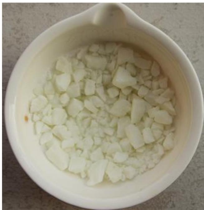
При охлаждении сульфаты уменьшают свой объем сильнее, чем фарфор (в противоположность смеси  $\text{NaCl}/\text{CaCl}_2$ , которая растрескивает фарфор), поэтому они могут быть легко отделены путем переворачивания тигля и легкого постукивания. Далее материал был измельчен и размолот в ступке.
