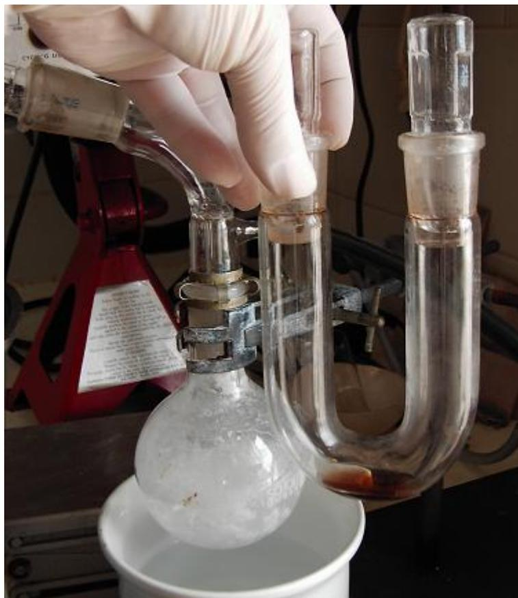
Небольшие примеси обугленной органики, которые окрашивали  $\text{SO}_3$ , остались в U-образной трубке вместе с 37% олеумом. В момент разъединения установки и накрытия шлифов пробками образовался дым  $\text{SO}_3$ . Количество дыма было таким большим, что вытяжка не справлялась, и работающим пришлось на время покинуть лабораторию. На любых других стадиях анализа образование дыма не происходило.
