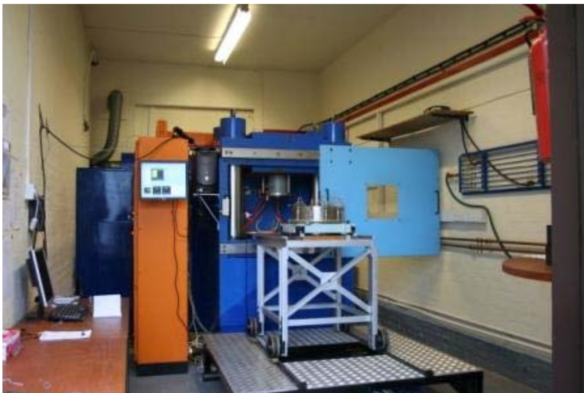
Установка, способная создавать давление до 10 ГПа (1 млн. атм.) при температуре до 3000 °C (warwick.ac.uk).
