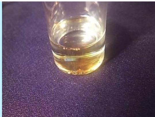
Начало реакции платины с царской водкой при комнатной температуре. Внизу, возле кусочков платины, видно слабое покраснение кислоты
