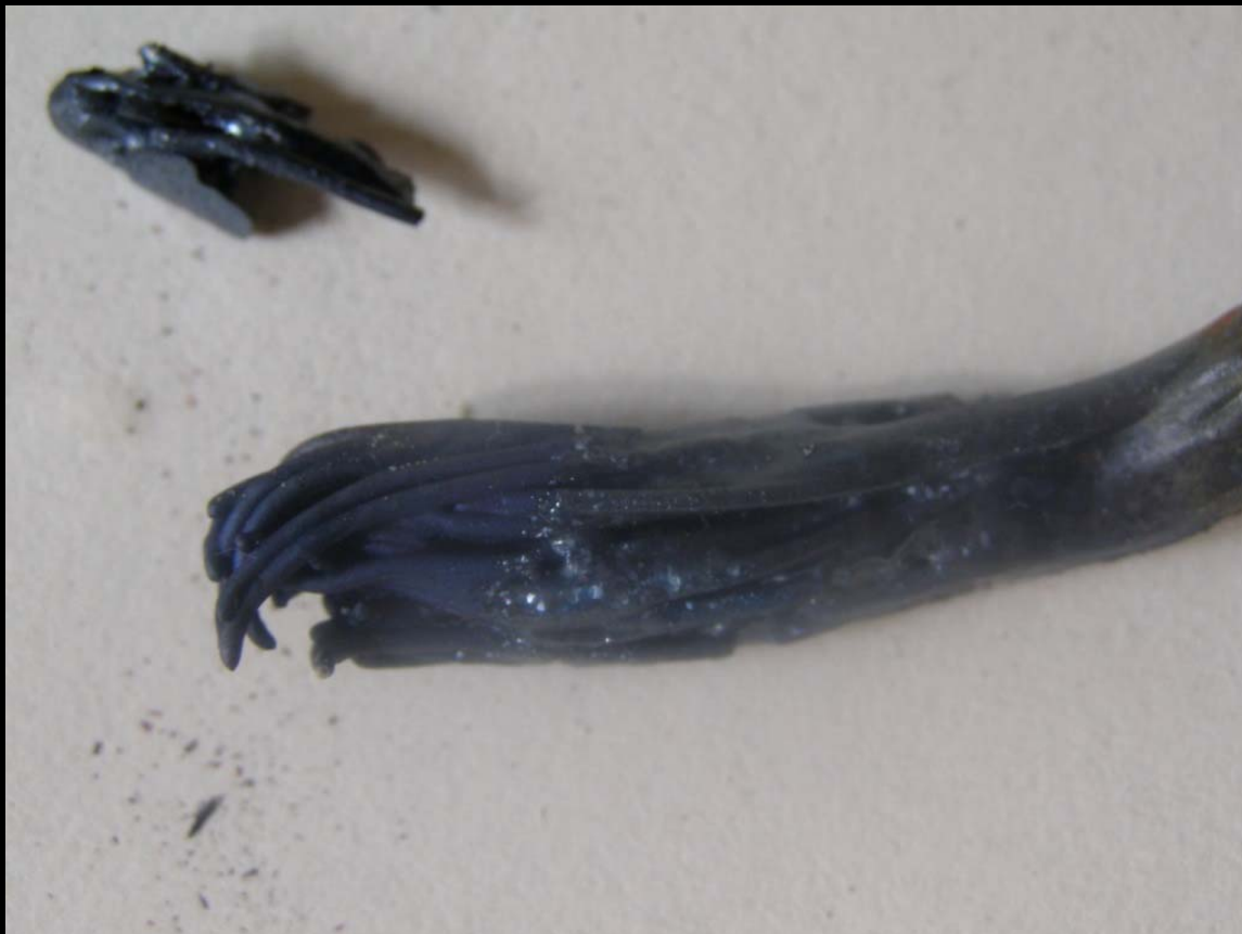
После сгорания меди остался черный сульфид \text{Cu}_2\text{S}
