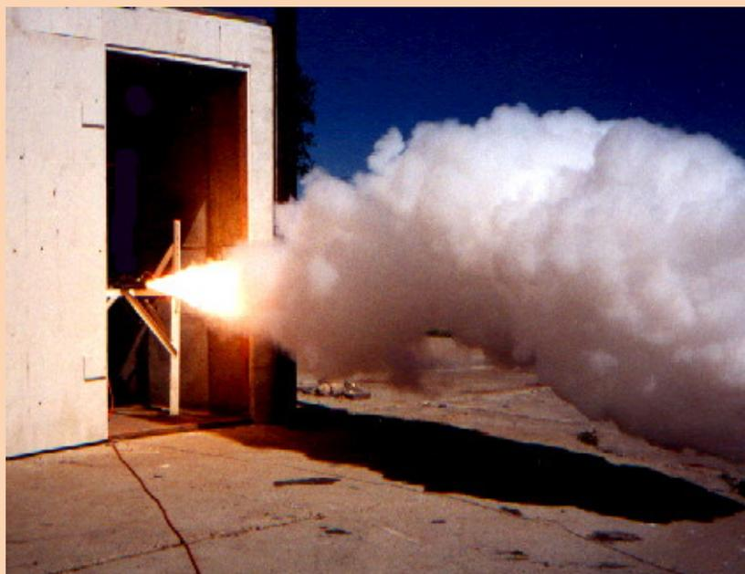
Испытание ракетного двигателя на смеси магний – углекислый газ
