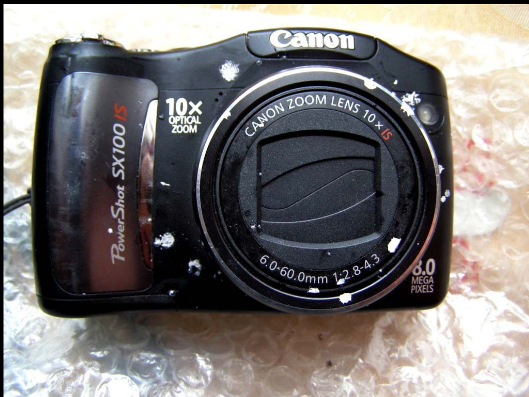
Фотоаппарат после съемки эксперимента. Пятна – брызги натрия
