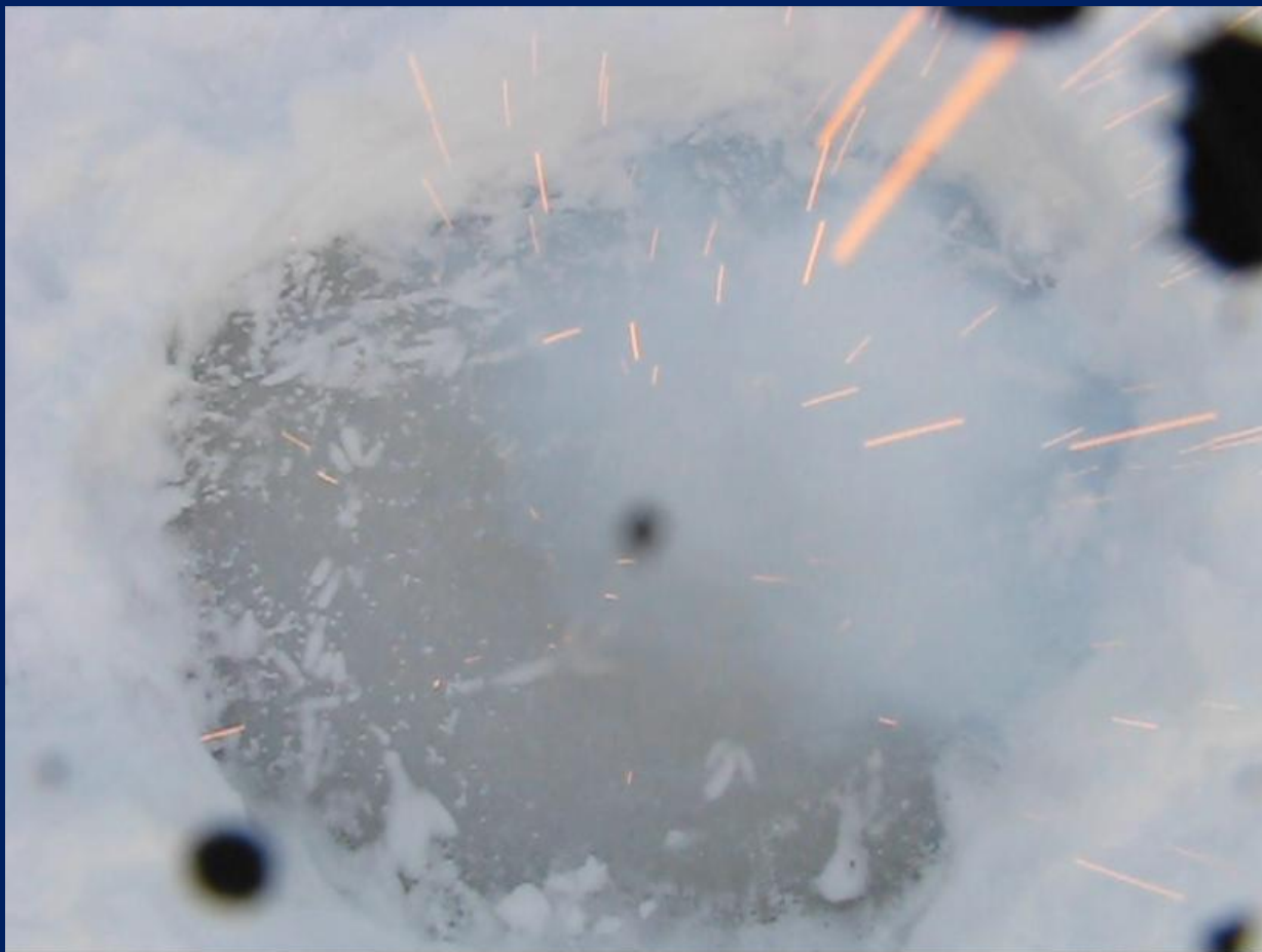
Черные пятна – брызги расплавленного натрия на объективе
