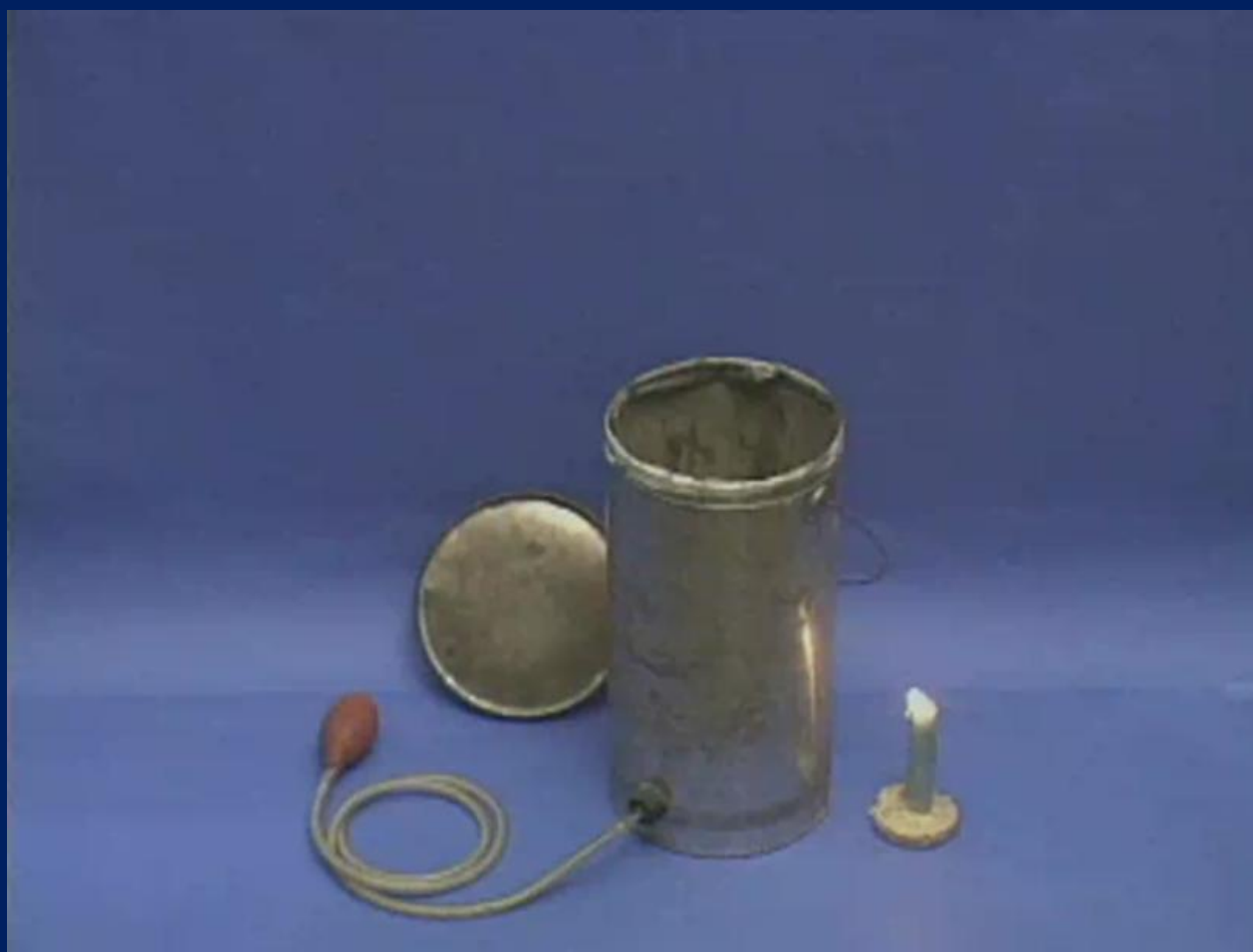
Взрыв смесь алюминиевая пудра – воздух в закрытом сосуде фото J. Chem. Ed.
