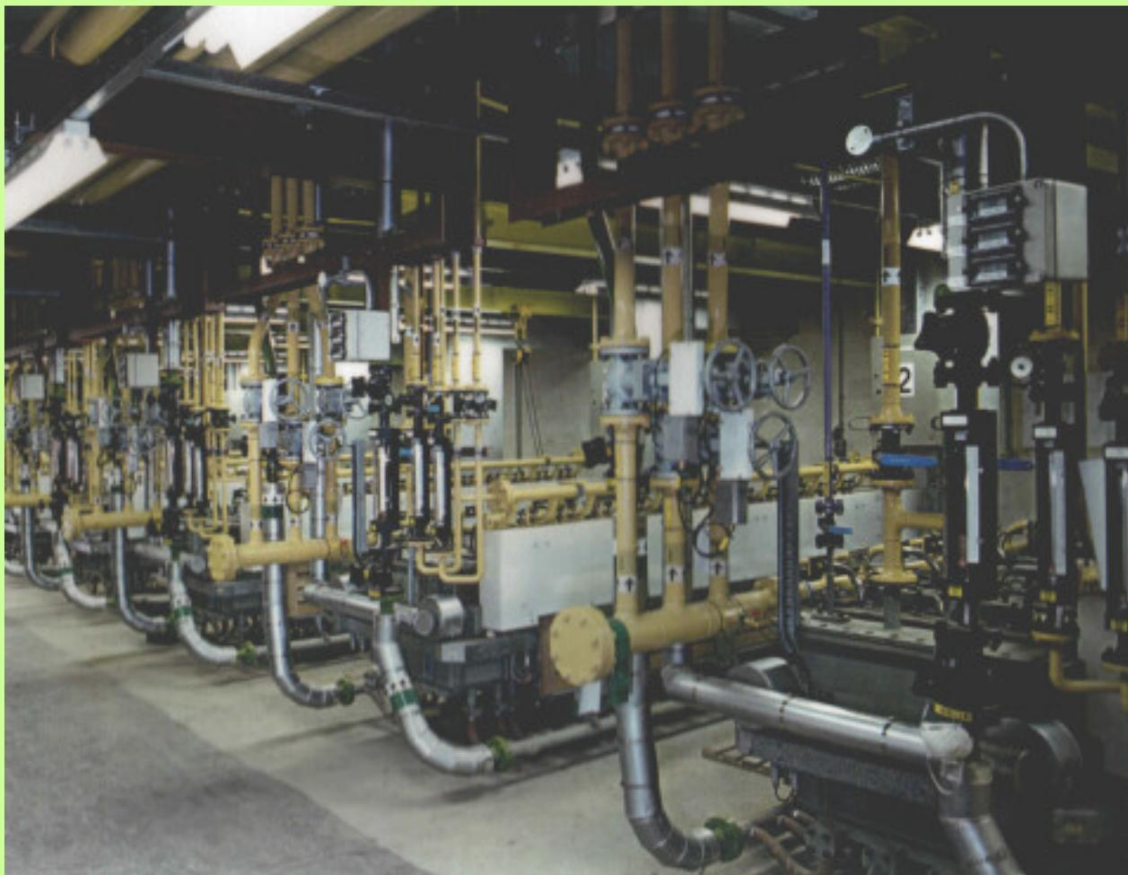
**Промышленная установка получения фтора электролизом**
