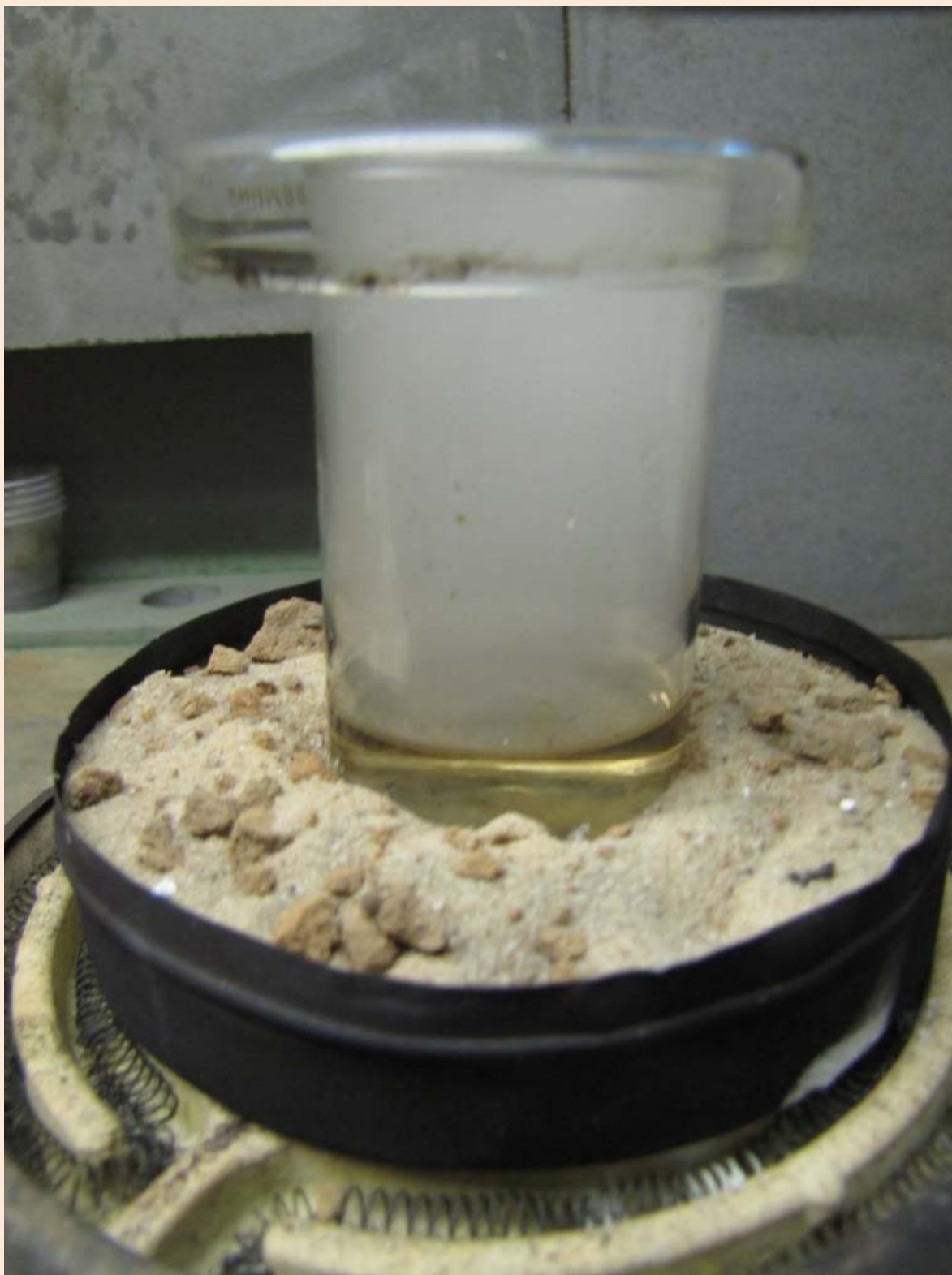
Кислота охлаждается после упаривания
