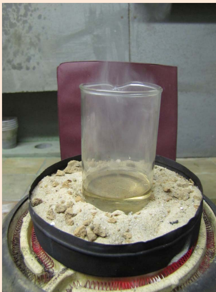
Упаривание серной кислоты фото В.Н. Витер
