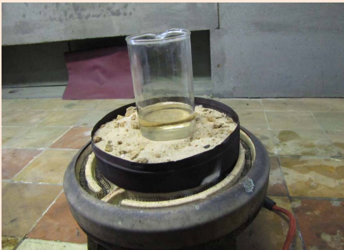
Упаривание серной кислоты фото В.Н. Витер
