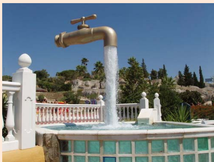
«Кран висит в воздухе». На самом деле, кран опирается на трубу, спрятанную в потоке воды
