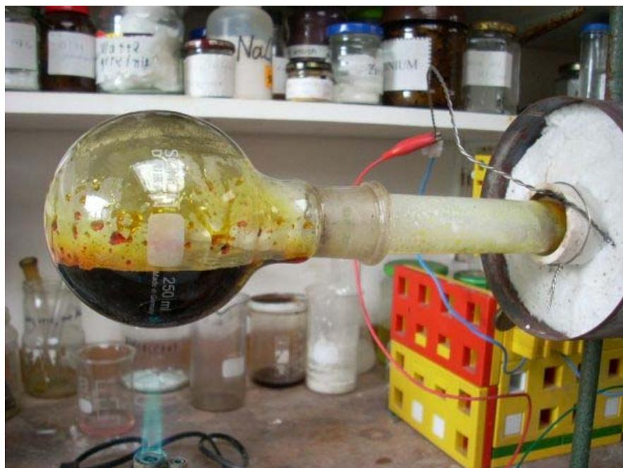
Когда пары серы достигли слоя угля, в правой части установки появился желтый туман. Непрореагировавшая сера конденсировалась на стекловате. На снимке также виден электронный термометр (на основе термопары).
