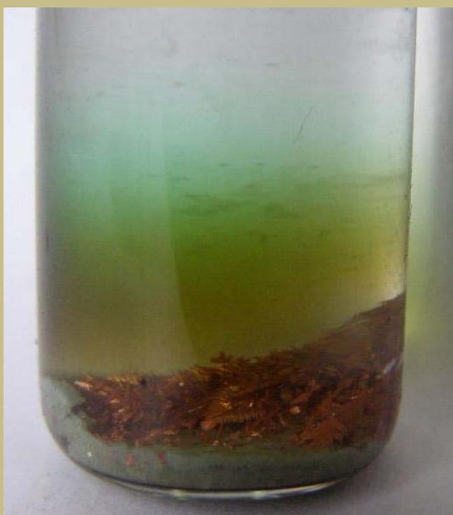
Вот какие кристаллы меди выросли на графитовом стержне всего через сутки. Часть красивых кристаллов осела на дно.
