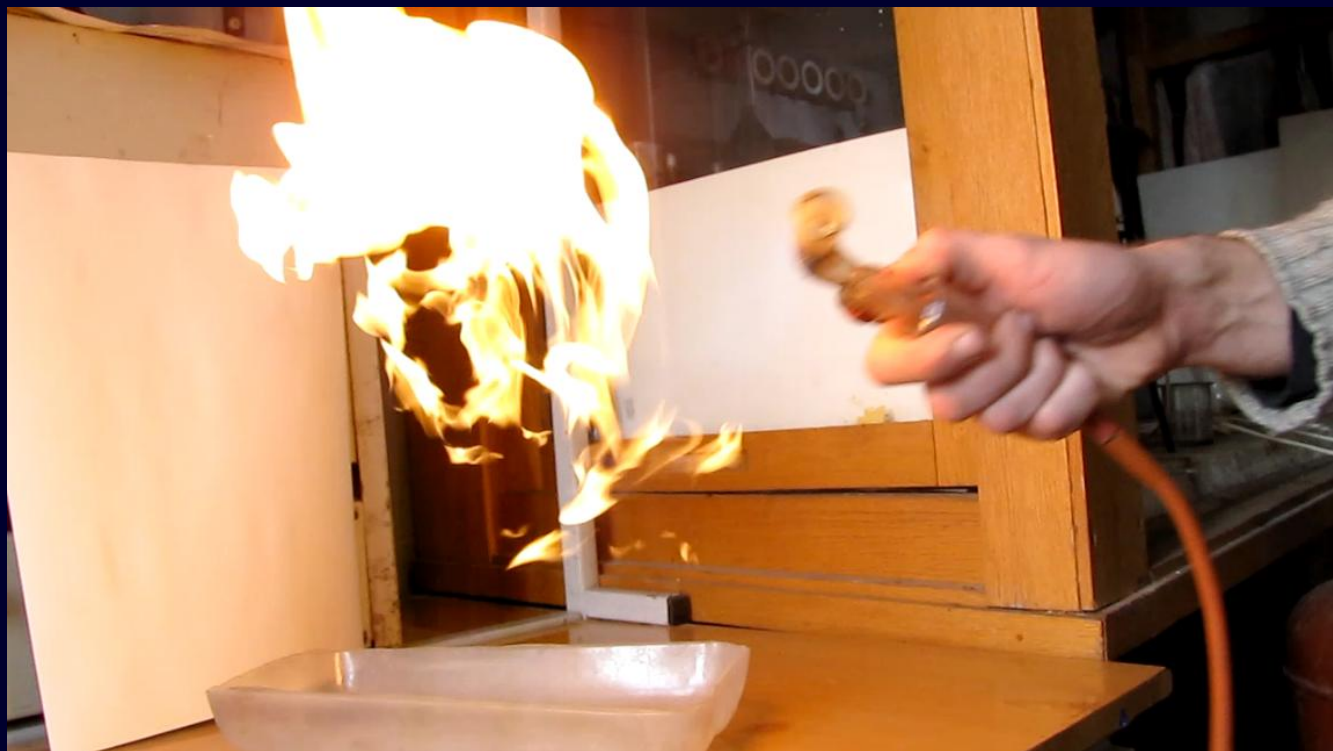
Когда на трубку подули сбоку, пламя «оторвалось» от источника
