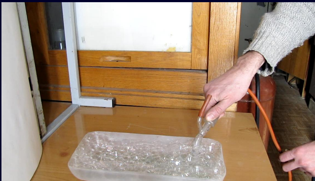
Горение пропан-бутановой пены в лотке фото В.Н. Витер
