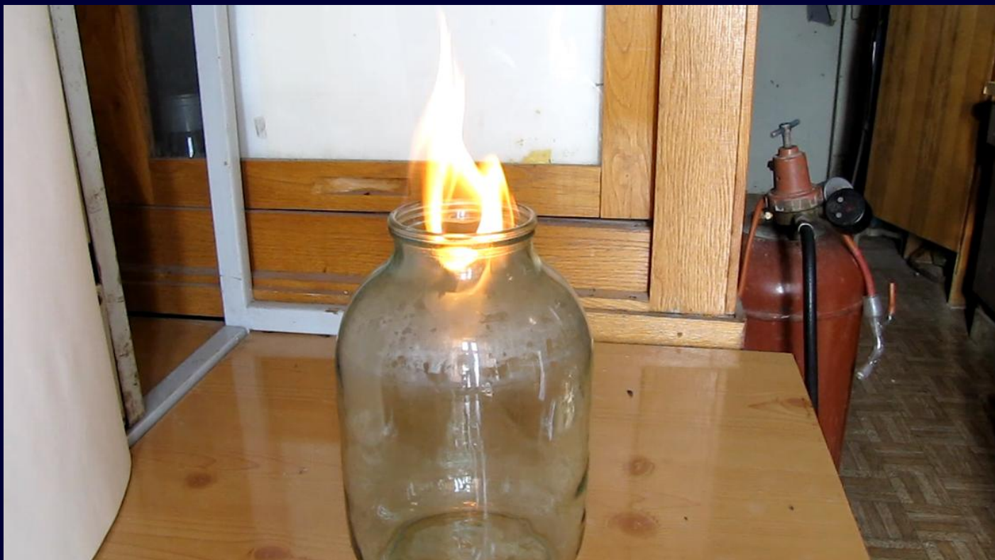
Горение пропан-бутановой смеси в трехлитровой банке фото В.Н. Витер
