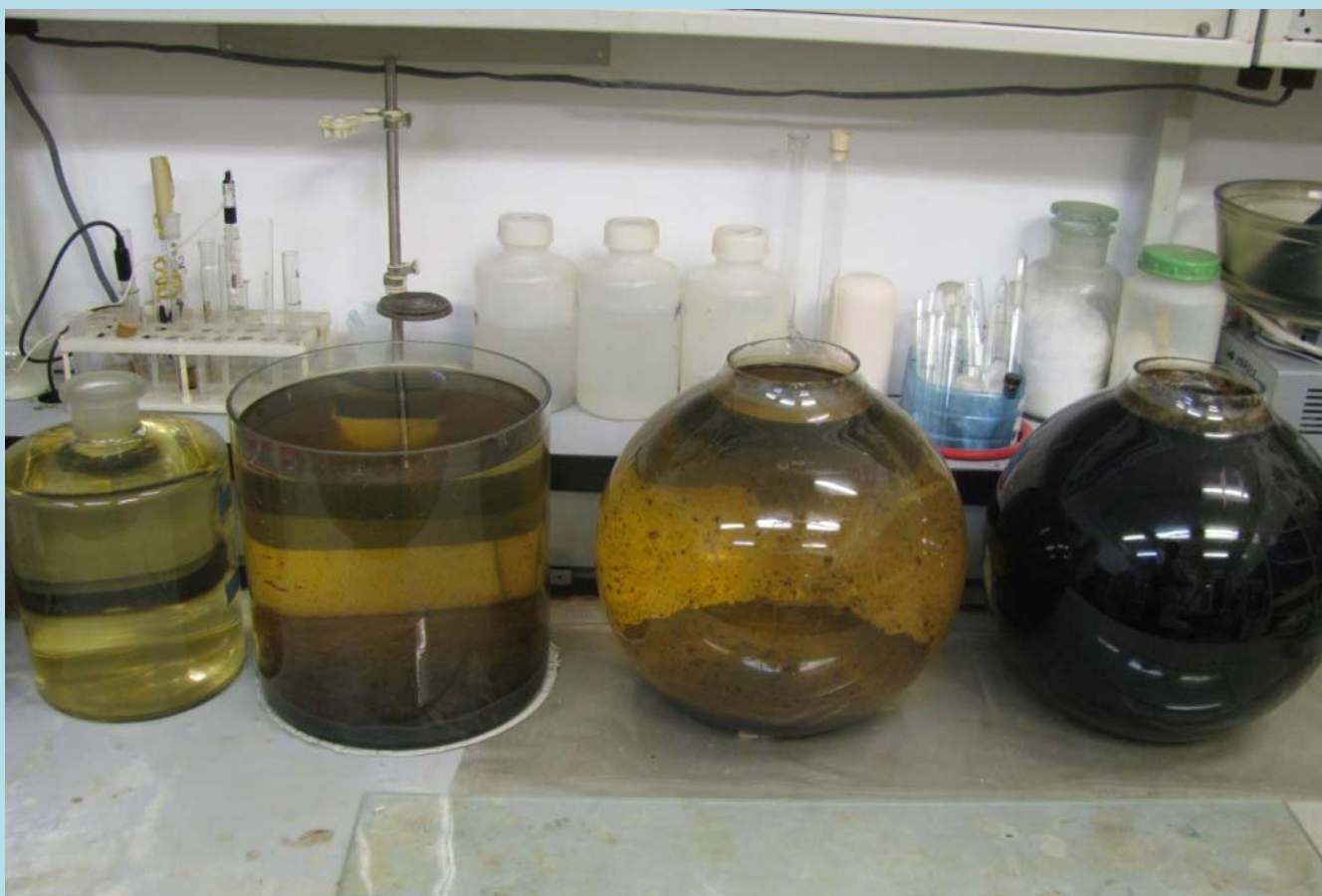
Модельные системы (металл – вода – донные отложения)
