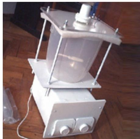
Нагревательный элемент отделен от корпуса прибора стекловатой, а от ведра - алюминиевой пластиной. Благодаря малой теплопроводности ведра при заданной постоянной температуре отклонения температуры от выбранного значения малы.
