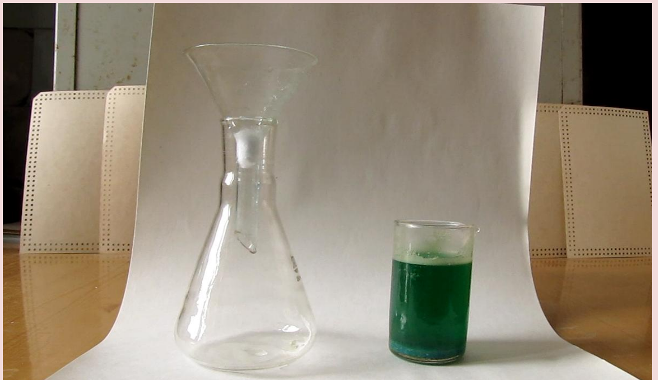
Реакция алюминия со смесью сульфата меди и хлорида натрия
