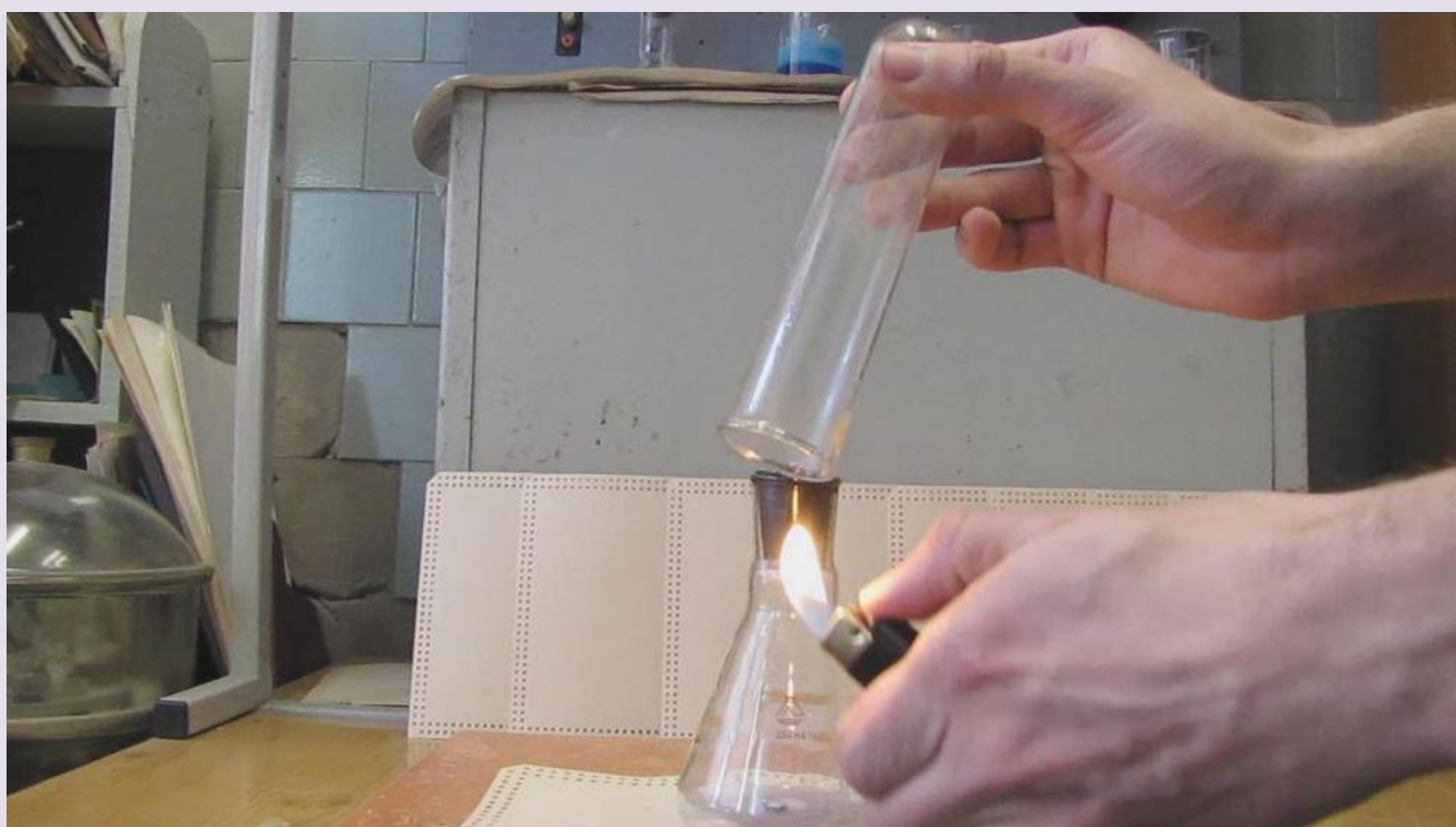
Взрыв водорода (широкая пробирка, банка из-под пива, литровая пластиковая бутылка)
