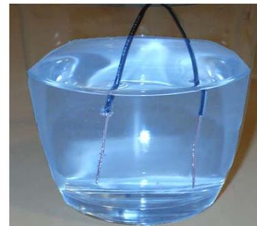
время мы увидим на длинной пластинке батарейки осадок меди, которая выделилась из раствора. Можно и без пропускания тока выделить медь из раствора медного купороса. Простой железный гвоздь, опущенный в раствор, через несколько минут покрывается красным налетом меди.
