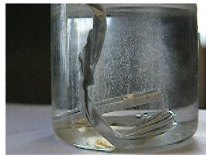
расходовалось, так как часть железа растворилась в ней, образовав зеленоватый раствор хлорида железа (II). Сольем раствор с остатка в другую пробирку и отфильтруем. На фильтре остаются частички угля, которые попадают в железо при выплавке в доменной печи.
