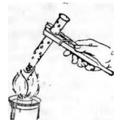
Поместим в пробирку немного медного купороса (химики называют его сульфатом меди) и нагреем на спиртовке. Мы увидим, как на стенке стеклянной пробирки осаждаются мелкие капли воды, а порошок изменяет свою окраску и становится серовато-белым. Накапаем несколько капель воды на порошок после охлаждения, и он снова
