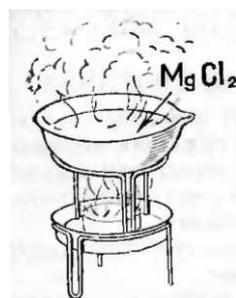
Этот процесс объясняется так: магний взаимодействует с соляной кислотой, вытесняя из нее водород, а оставшийся кислотный остаток соединяется с магнием, образуя соль — хлорид магния.
