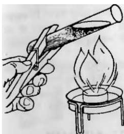
Белок во второй пробирке разбавим вчетверо водой и хорошенько встряхнем. Прозрачную белковую жидкость нагреем, но только в верхней половине пробирки с тем, чтобы появившееся изменение можно было сравнить с ненагретым белком. Нагретая часть жидкости скоро мутнеет, что свидетельствует о способности белка
