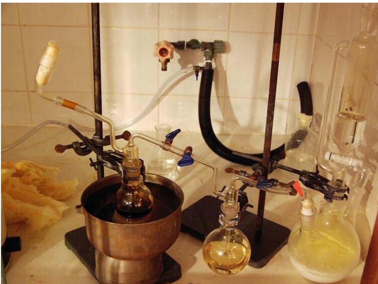
Жидкость сразу же начала краснеть – в конце процесса она стала почти черной (тонкий слой продукта все равно выглядел красным). В это время на выходе из системы поток газа полностью отсутствовал, хотя на поверхности жидкости наблюдались небольшие возмущения. Когда содержимое нагрелось до  $36^\circ C$ , в
