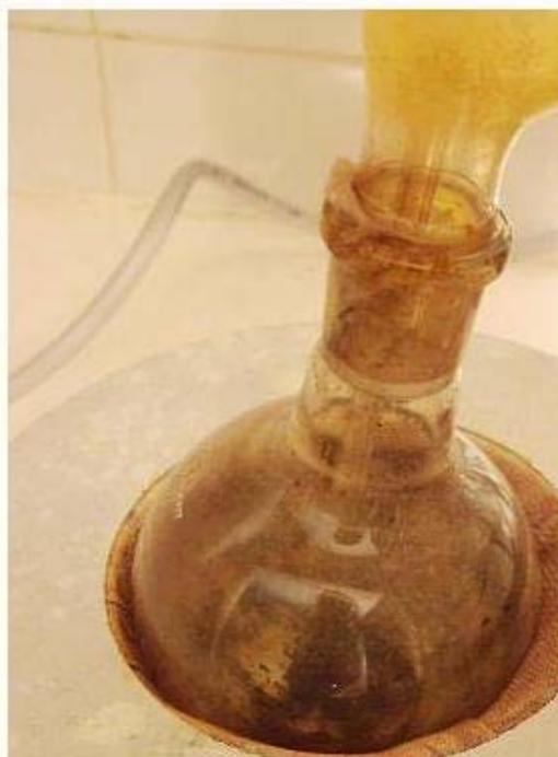
Поток хлора был остановлен, приемник взвешен. Масса продукта составляла 208 гр, что соответствует выходу 98% в пересчете на израсходованную серу.
