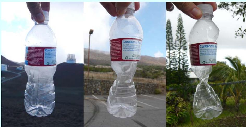
Пластиковая бутылка, которую закрутили на высоте 4.3 км, а потом опустили на высоту 2.7 км (рис. в центре) и 0.3 км (рис. справа). В результате возрастания давления бутылка сжимается
