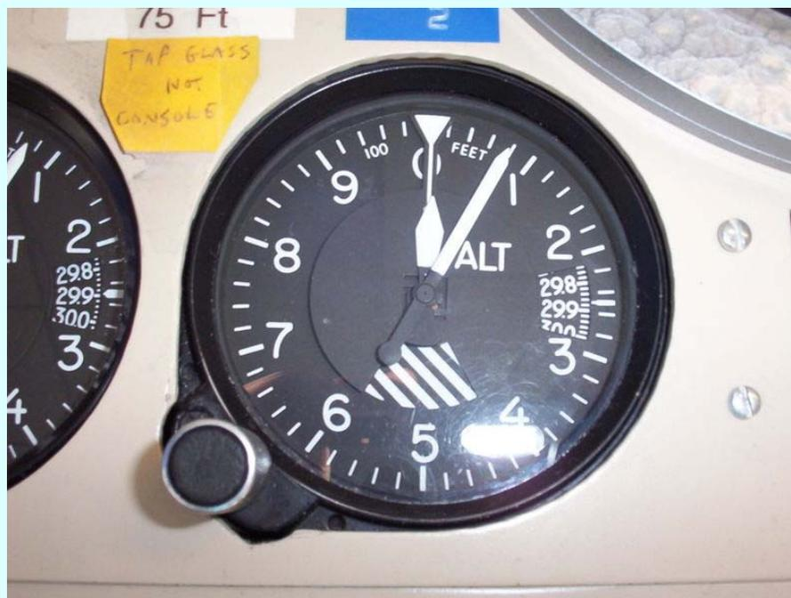
**Барометрический альтиметр (высотомер) – навигационный прибор, указывающий высоту полета**
