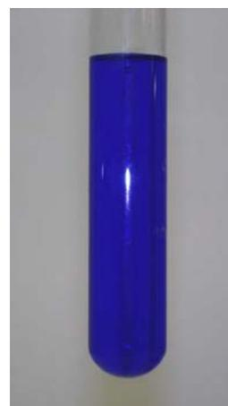
разложения еле заметны, в третьей пробирке, содержащей соединение аммиака с медью, происходит бурная реакция разложения перекиси водорода.
