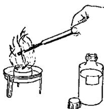
Смочим медную проволоку или латунную пластинку в соляной кислоте и поместим в пламя спиртовки. Через некоторое время пламя станет яркозеленым. Медь, из которой изготовлена медная проволока и которая входит в состав латуни, вызывает это изменение окраски пламени.
