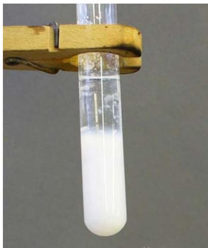
Возьмем жидкое стекло — силикатный клей канторский (силикат натрия) и нальем на 1/4 пробирку.
