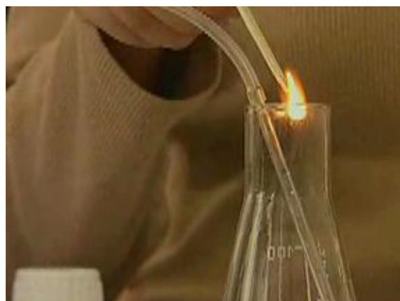
порошок начинает чернеть, поднесем к свободному отверстию изогнутой трубки чашку с водой так, чтобы конец трубки слегка опустился в воду. Мы увидим массу пузырьков, поднимающихся в воде от свободного конца трубки. Если поднести к отверстию трубки тлеющую лучину, она вспыхнет и энергично загорится.
