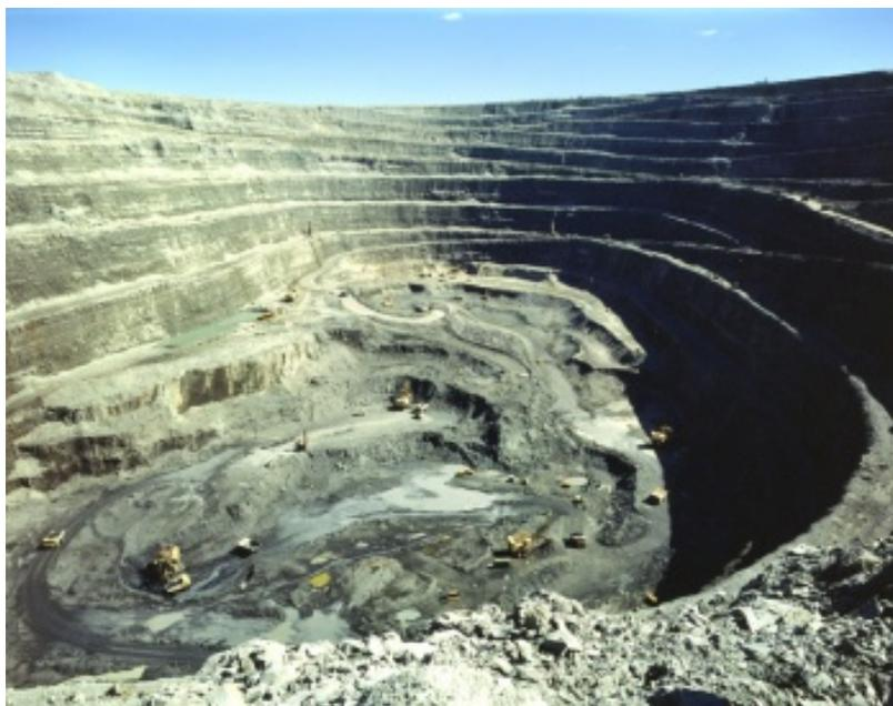
**Неподалеку от трубки “Зарница”, на том же ручье Далдын в 1955 была открыта трубка “Удачная”, выработанная за 45 лет до глубины 1400 метров.**
