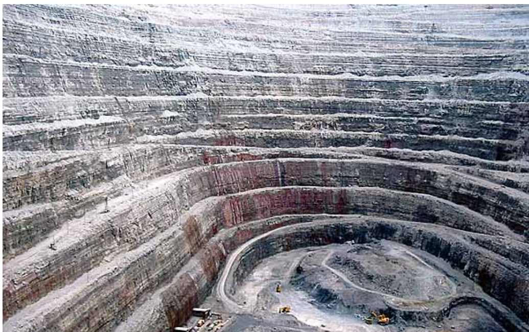
Карьер на кимберлитовой трубке «Зарница» (июль 2004 г.). Кольцевые уступы — дороги, по которым идут стотонные самосвалы.
