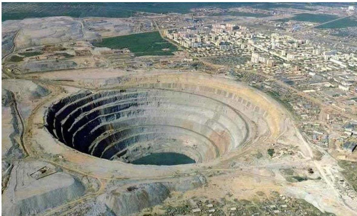
Кимберлитовая трубка, алмазный карьер МИР. г Мирный, Якутия. глубина - 525 м, верхний диаметр 1200 - 1100 м, нижний 50 - 210 м. длина спирального съезда - 7,5 км глубина залегания алмазной руды - до 1,2 км. Закрыт 1 мая 2001г. Сейчас добыча идет шахтным методом.
