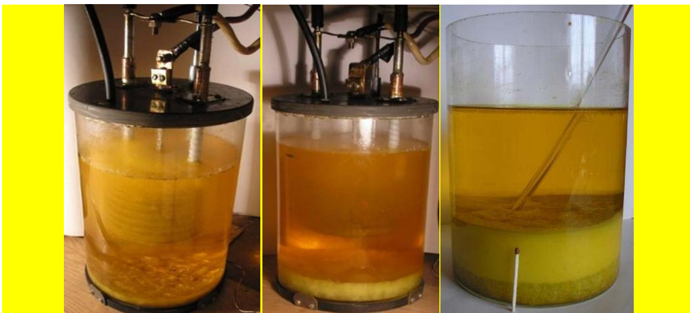
Слева - установка для электрохимического синтеза \text{KClO}_3 .
