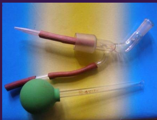
Рис. 1б. Вместо резиновой пробки с трубками удобно использовать стеклянную насадку
