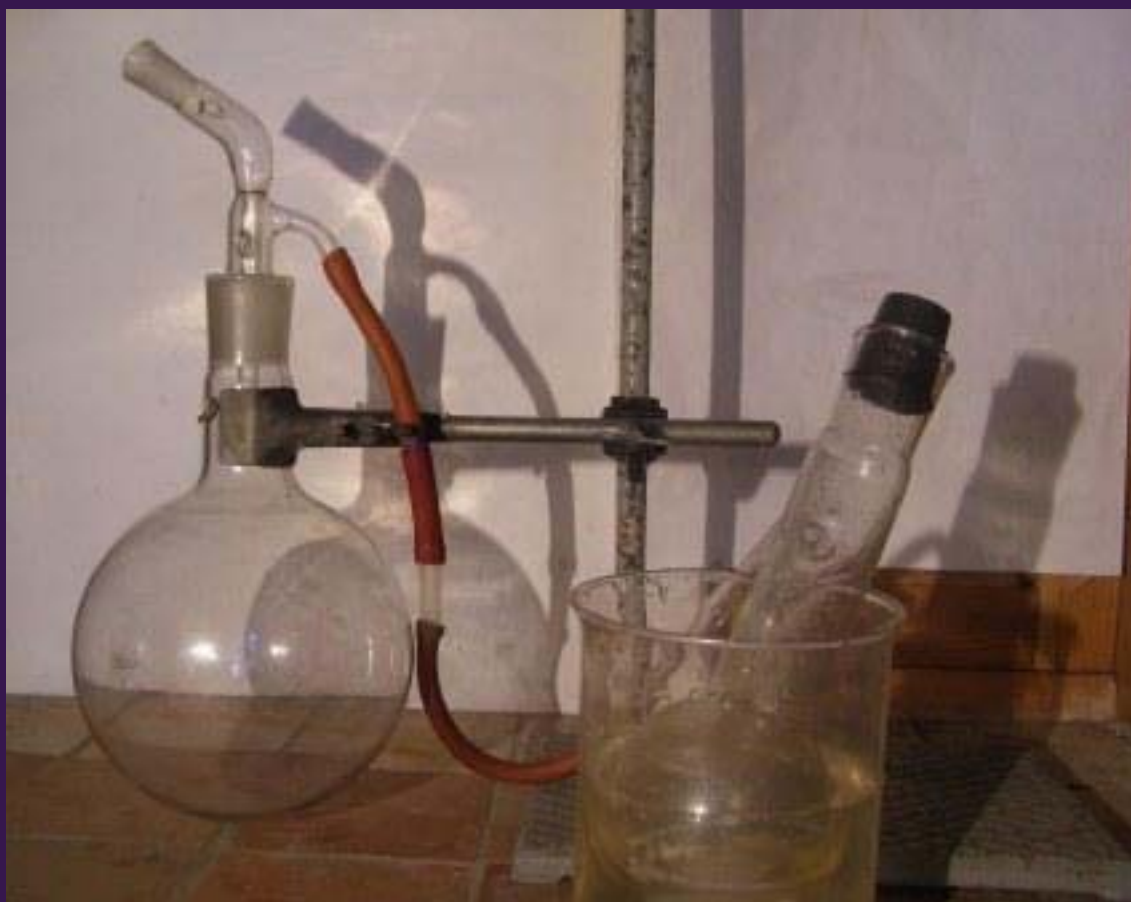
Заполним колбу хлороводородом
