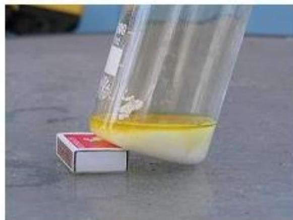
В результате раствор  $\text{HClO}_4$  сильно пенится, а на дно выпадали белые кристаллы моногидрата перхлората нитрозила ( $\text{NOClO}_4 \cdot \text{H}_2\text{O}$ ). Важно чтобы над поверхностью жидкости оставалось достаточно свободного места, поскольку образуется много пены.
