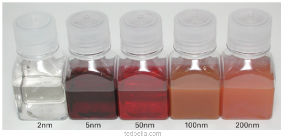
Коллоидные растворы золота с разным размером частиц
