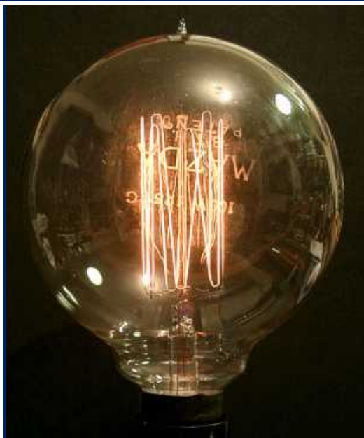
Одна из первых ламп с вольфрамовой нитью
