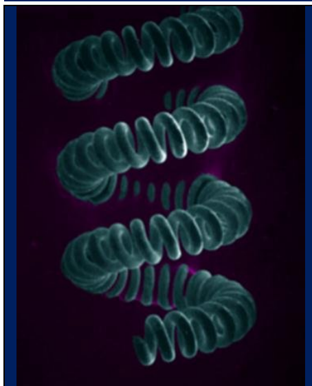
Вольфрамовая спираль лампы при увеличении в 75 раз. mirf.ru
