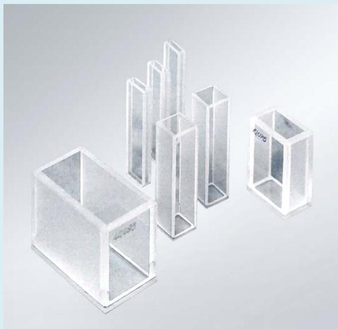
Исследуемый раствор наливают в специальные кюветы из оптического кварцевого стекла. С кюветами для фотометрии нужно обращаться очень аккуратно, содержать их в идеальной чистоте. Можно прикасаться только к боковой поверхности кювет, через которую не проходит оптический луч
