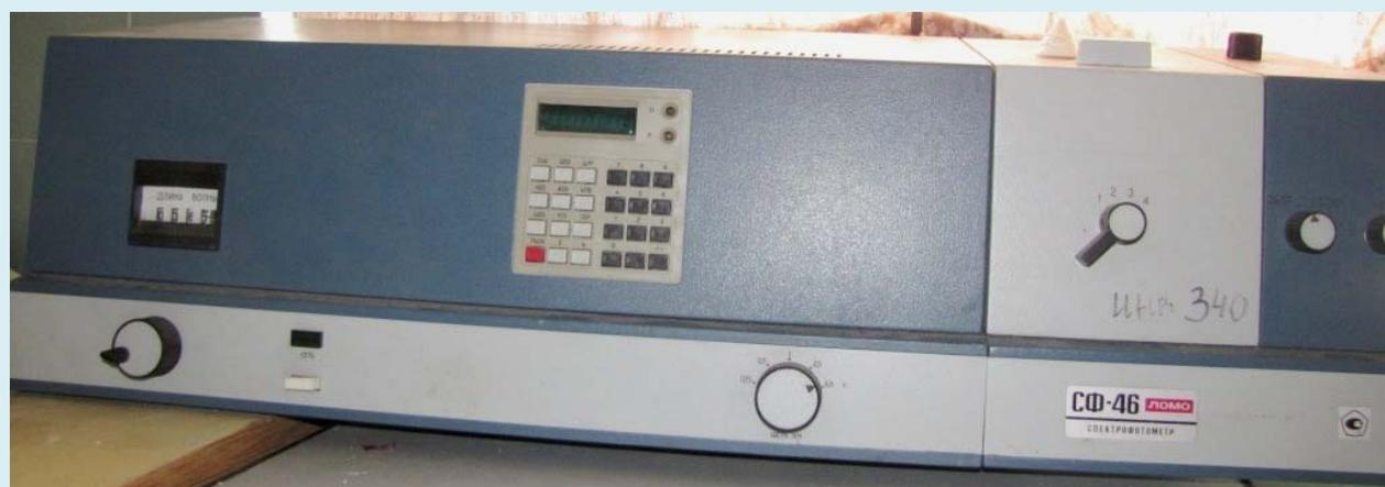
Спектрофотометр СФ-46 – распространенный прибор для фотометрического анализа и исследования спектральных характеристик растворов.
