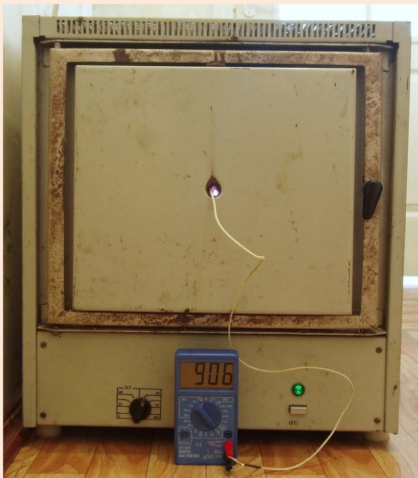
Отремонтированный муфель СНОЛ старой модели. В окошко дверцы вставлена термопара (от тестера)
