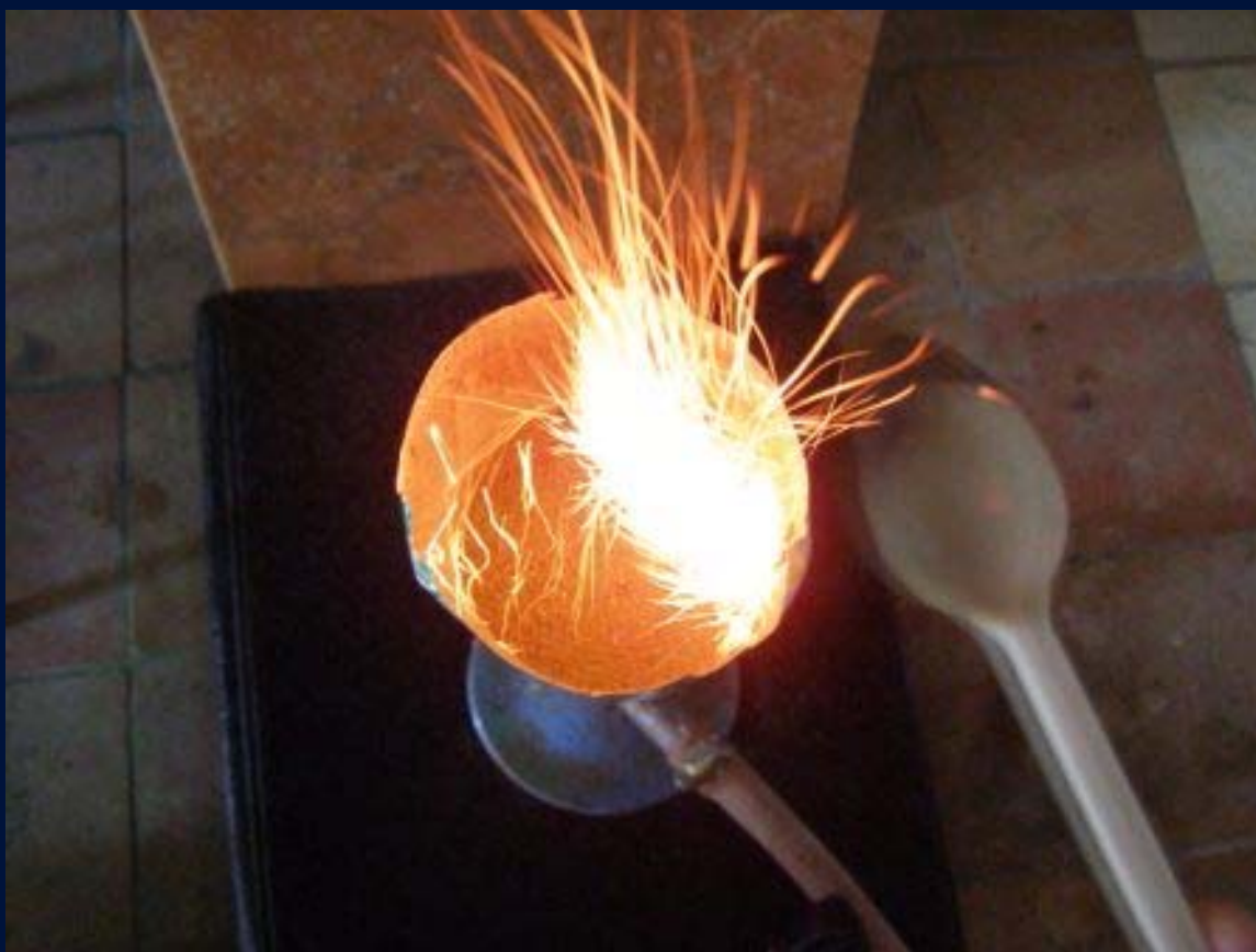
Работа каталитической горелки на пропан-бутановой смеси
