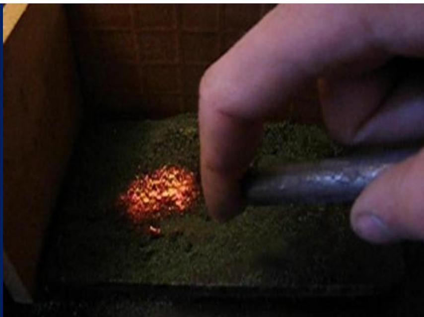
Таким способом мы можем продемонстрировать зрителям, что пламя горелки погашено и  $\text{Cr}_2\text{O}_3$  раскалился за счет каталитического окисления углеводородов
