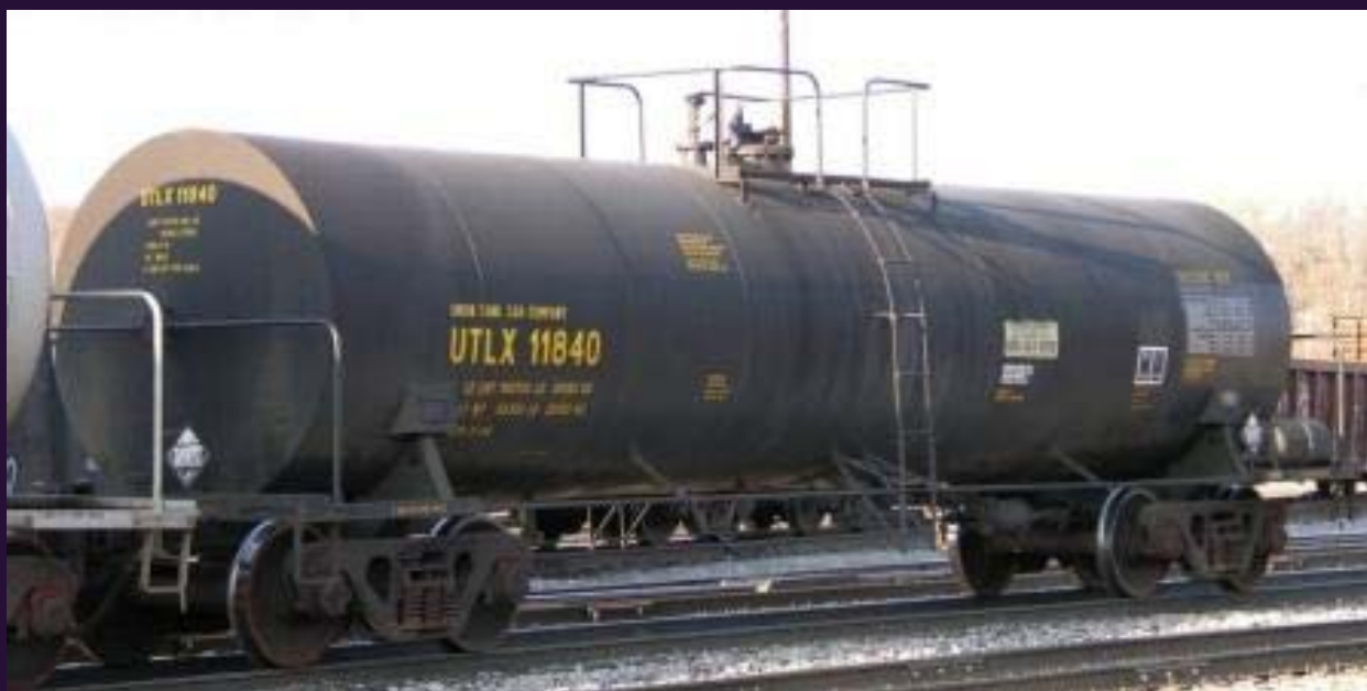
Цистерна с концентрированной серной кислотой krunk.org
