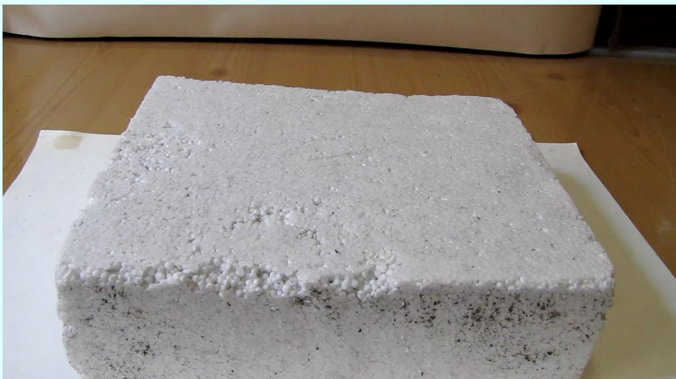
Ацетон быстро разрушает пенопласт
