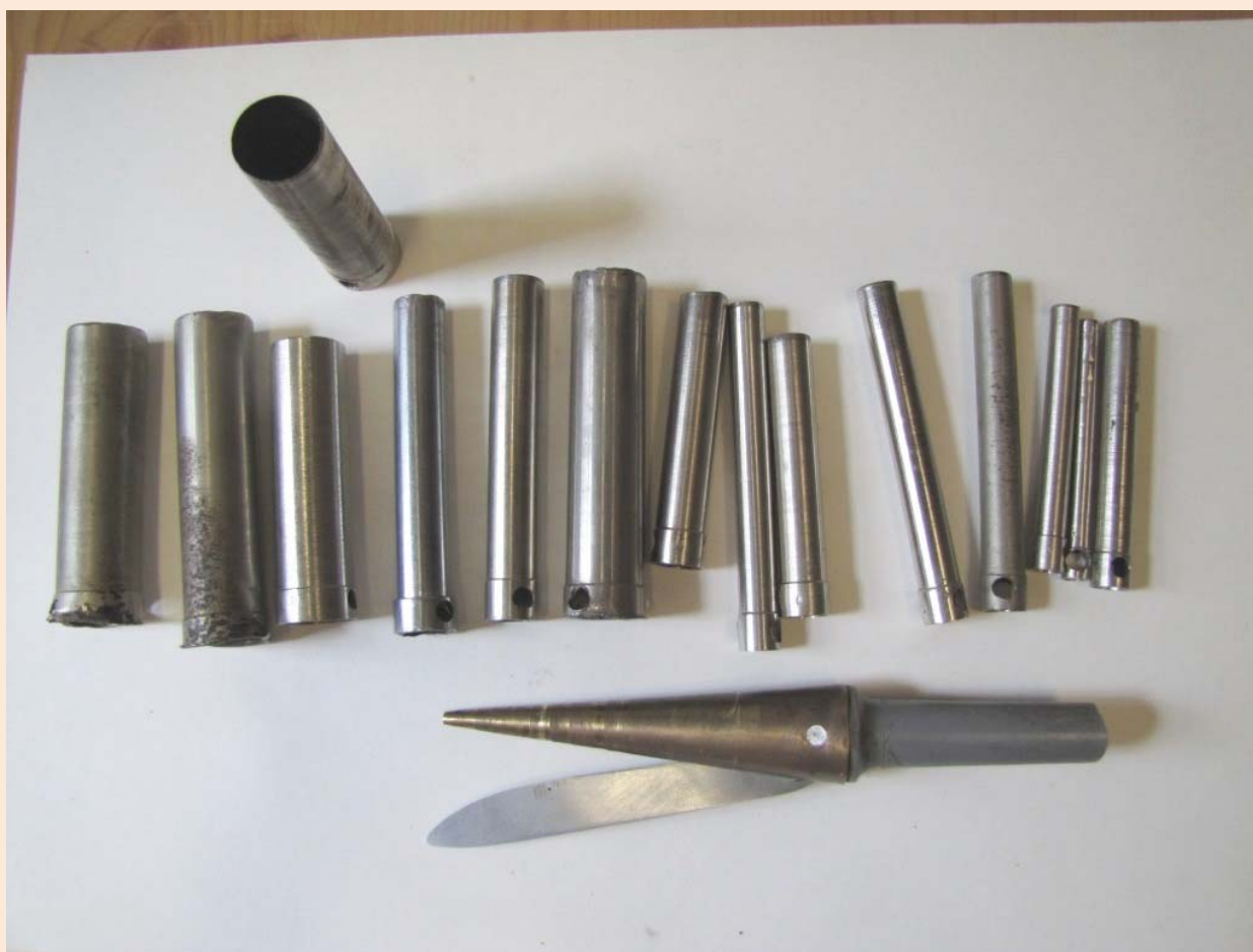
Сверла для пробок и нож для их заточки фото В.Н. Витер
