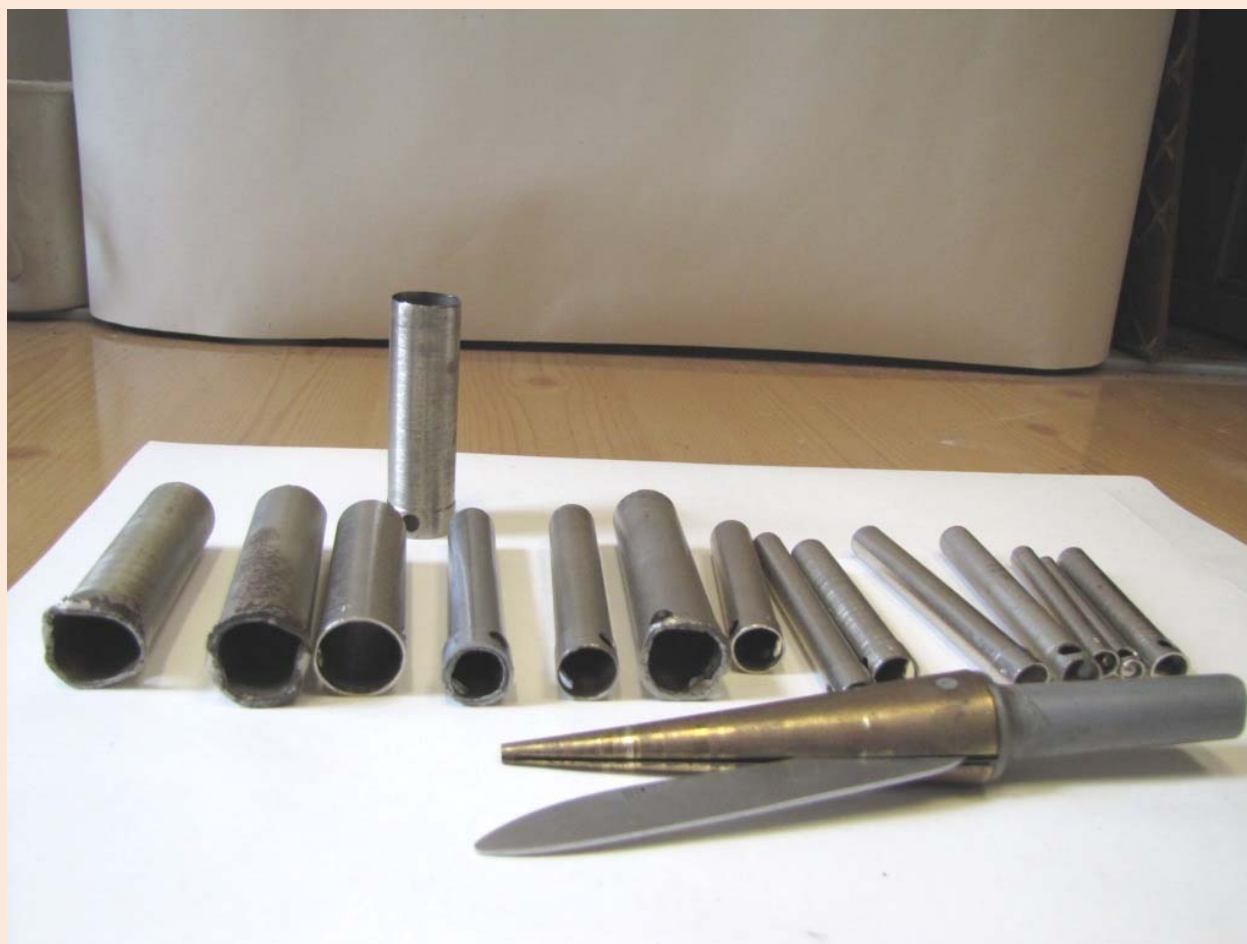
Сверла для пробок и нож для их заточки фото В.Н. Витер
