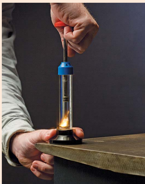
Рис. 7. Воспламенение спичечных головок при резком сжатии воздуха в стеклянном цилиндре
