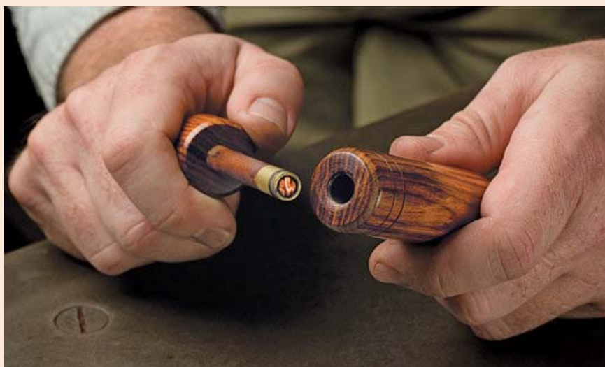
Рис. 5. Приспособление для добывания огня путем резкого сжатия воздуха
