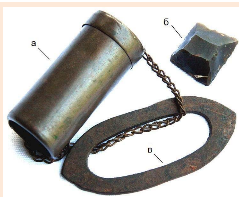
Рис. 4. Огниво начала XIX века: а – металлический футляр; б – кремь; в – стальное кресало
