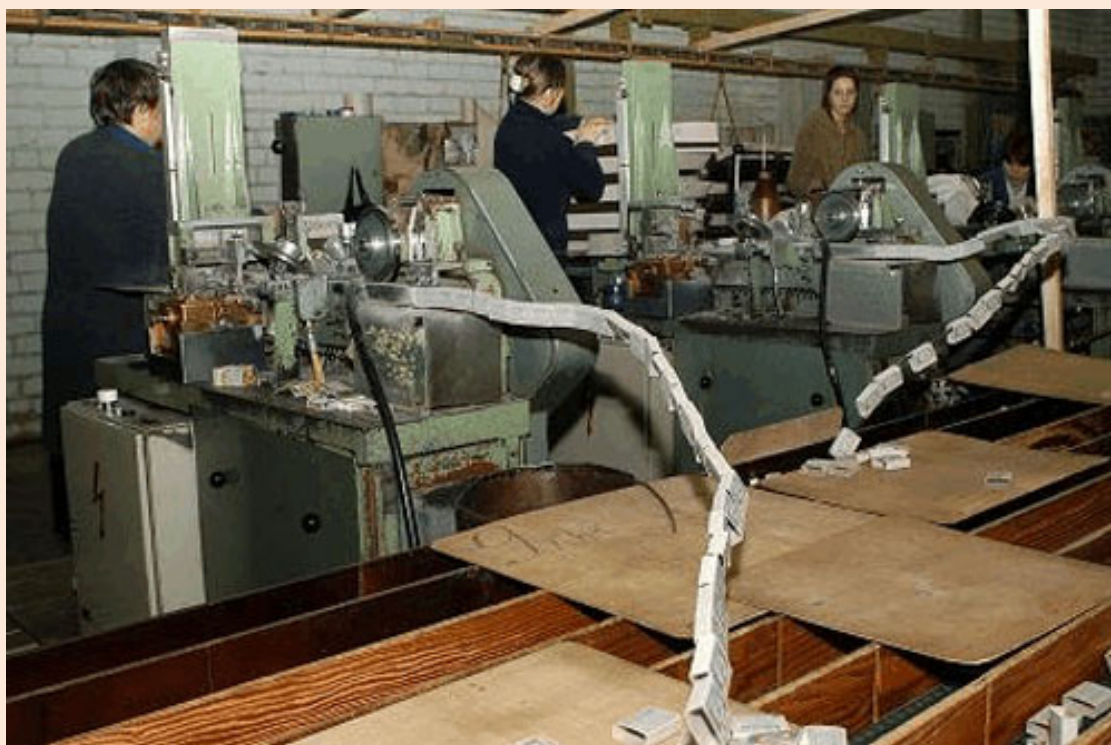
Изготовление спичечных коробков
