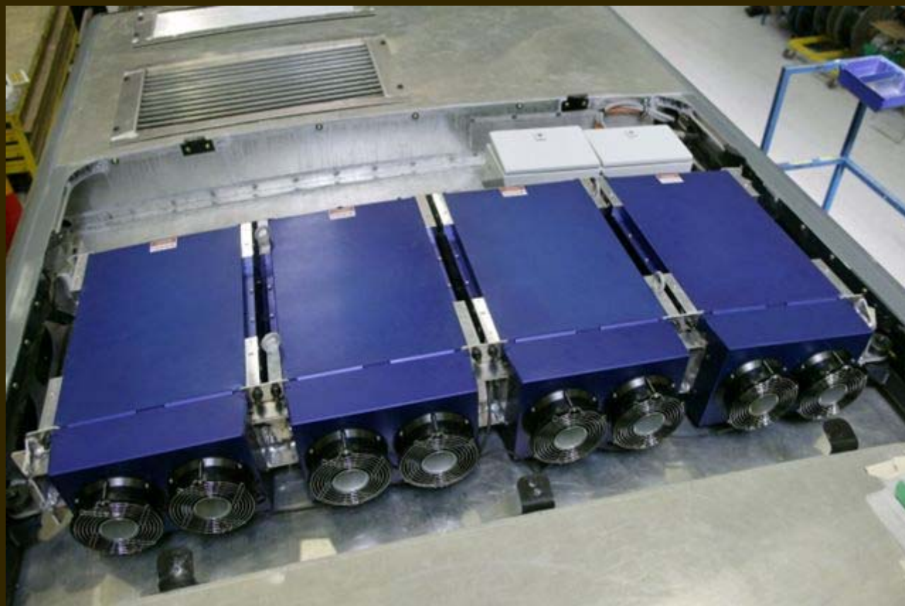
Батарея ионисторов на крыше автобуса jcwinnie.biz
