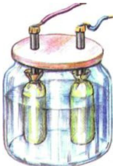
старого гальванического элемента и обвязывают вокруг них марлевые мешочки с активированным углем. В качестве электролита употребляется раствор КОН. (Раствор поваренной соли применять не следует, поскольку при ее разложении выделяется хлор.)
