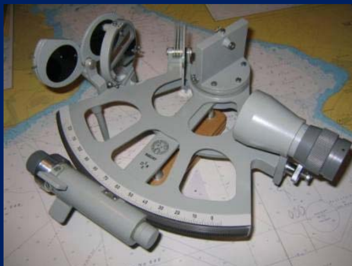
Секстант - современный измерительный прибор для определения угла между двумя объектами dic.academic.ru
