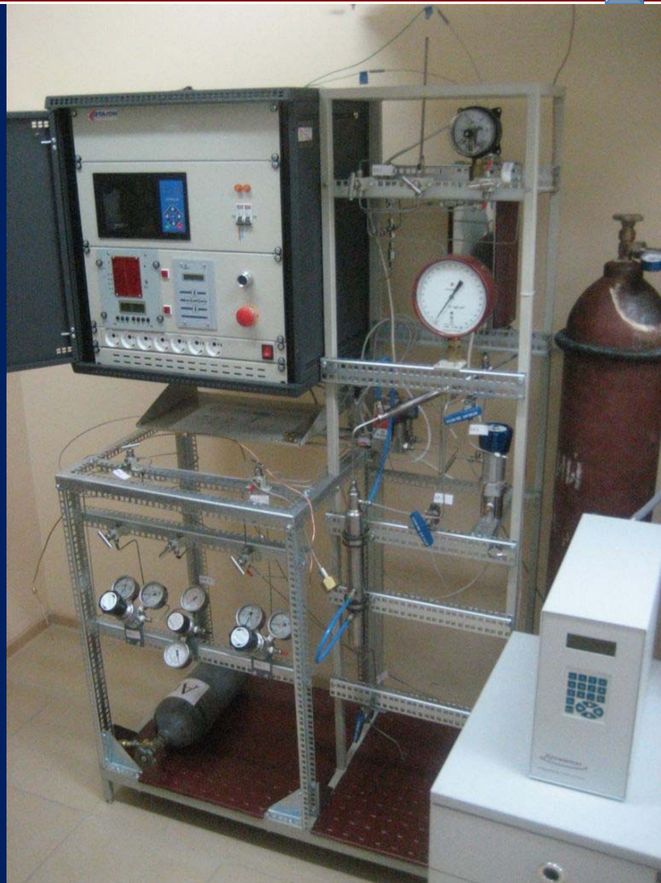
Лабораторная установка для исследования каталитических реакций ckp.tsu.ru
