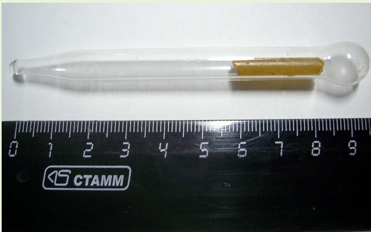
Желтый фосфор (технический белый фосфор). Палочки белого фосфора удобно изготавливать с помощью срезанного шприца под слоем воды
