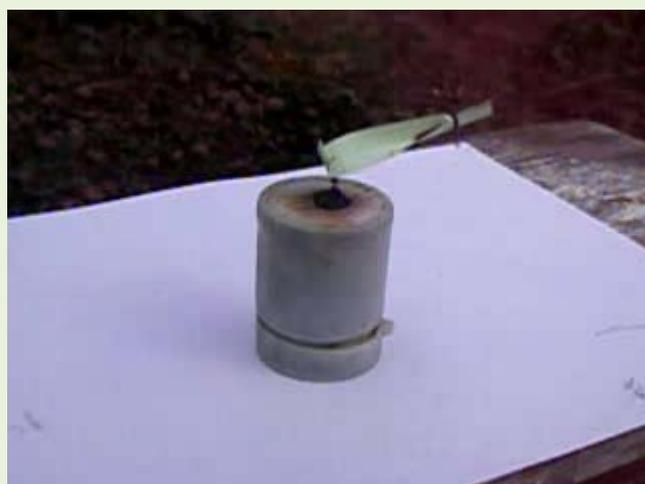
Смесь перманганата калия и концентрированной серной кислоты обладает сильными окислительными свойствами. При взаимодействии этих веществ образуется зеленый оксид марганца (VII)  $Mn_2O_7$ , который разлагается с образованием атомарного кислорода и озона.
