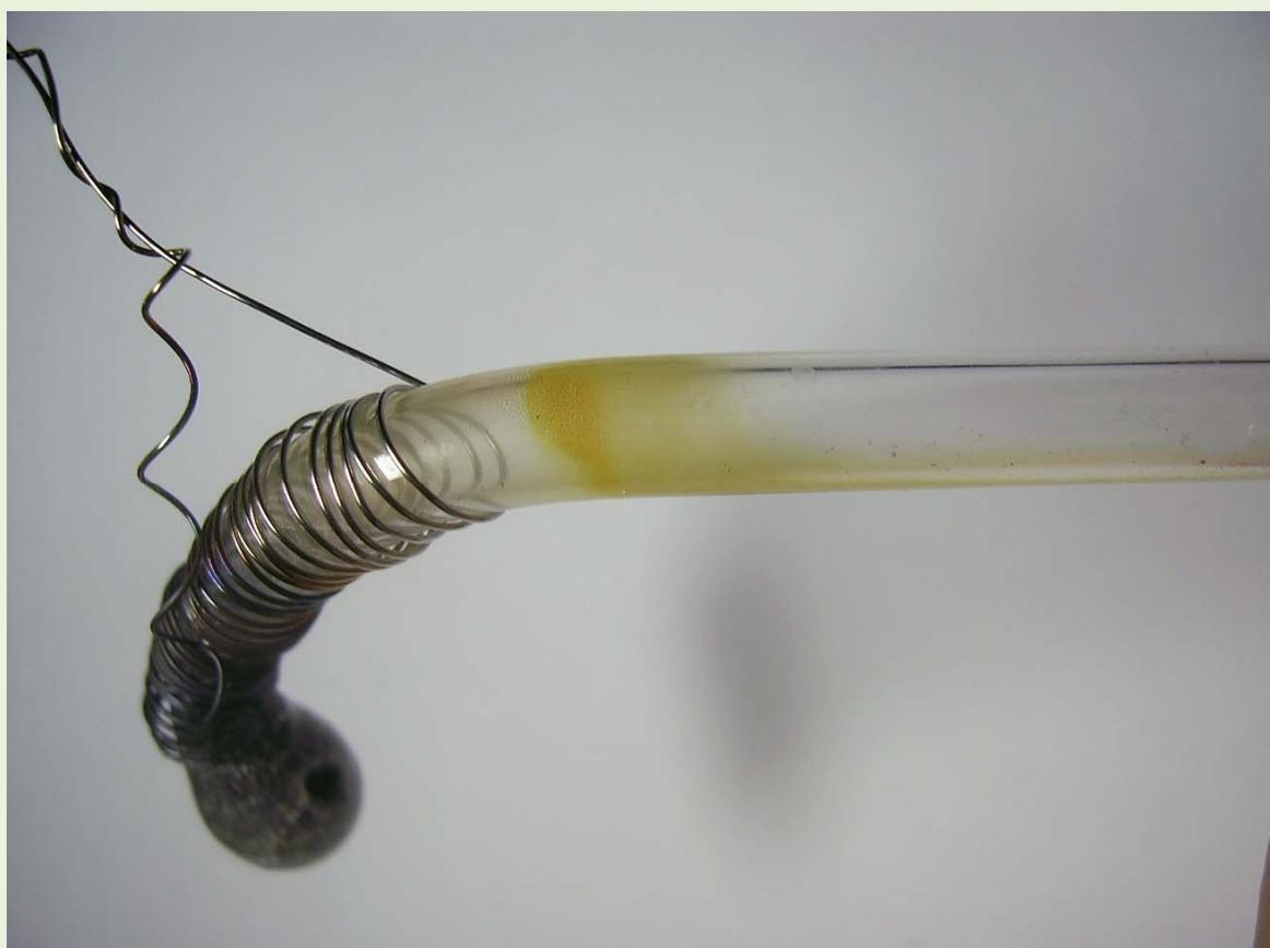
Небольшие количества паров фосфора конденсировались на поверхности стеклянной трубки в результате пробного эксперимента по получению белого фосфора
