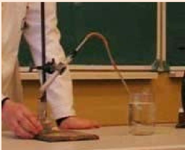
Для получения фосфина кусочки белого фосфора кипятят в концентрированном растворе щелочи. При соприкосновении с воздухом фосфин воспламеняется. Над поверхностью воды видно вспышки, при этом образуются характерные дымовые кольца. Опыт очень прост в исполнении и красив.
