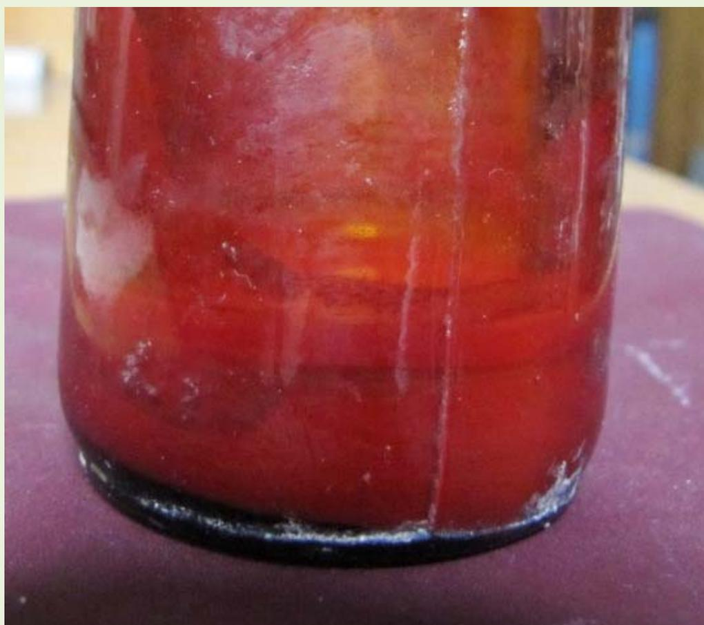
Технический красный фосфор часто содержит примеси белого фосфора, при хранении он покрывается пленкой полифосфорных кислот
