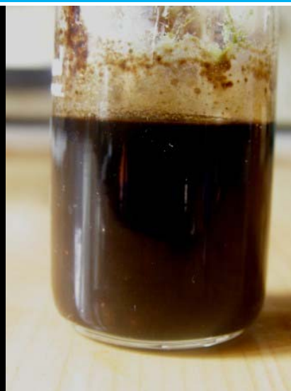
Растворение меди в смеси \text{CuSO}_4 и \text{NaCl} фото В.Н. Витер
