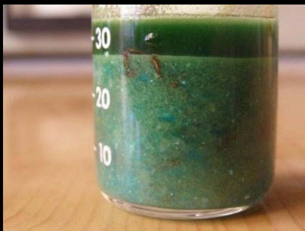
Растворение меди в смеси \text{CuSO}_4 и \text{NaCl} фото В.Н. Витер
