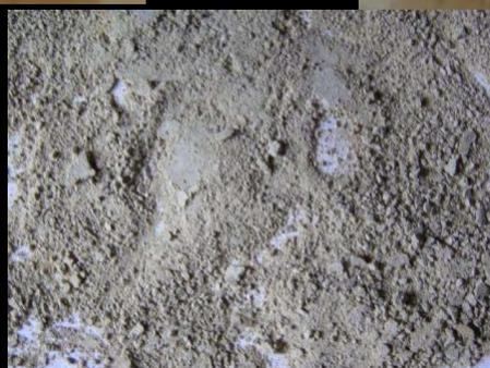
**Осаждение иодида меди  $\text{CuI}$ . Для синтеза был использован технический  $\text{CuSO}_4 \cdot 5\text{H}_2\text{O}$ , поэтому полученный продукт окрашен в сероватый цвет. Это не мешает использовать  $\text{CuI}$  для обнаружения паров ртути** фото В.Н. Витер
