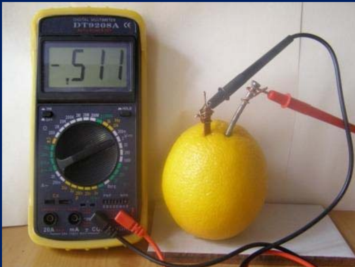
Батарейка из апельсина. Левый электрод медный, правый – железный (гвоздь)
