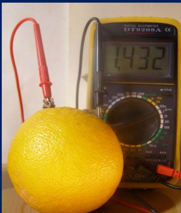
На левом рисунке подключены магниевый и медный электроды, на правом – магниевый и железный
