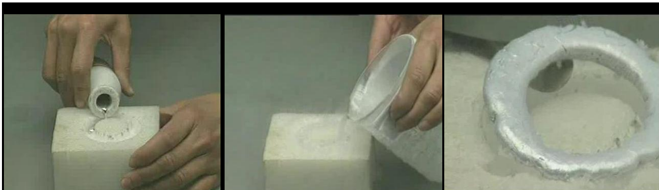
Замораживание ртути жидким азотом
