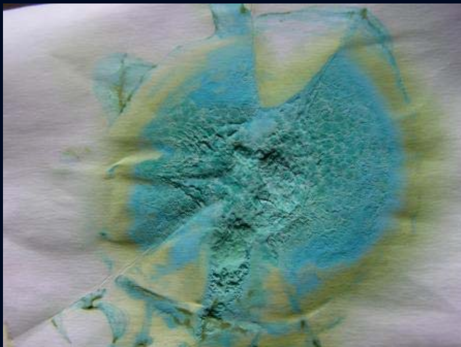
Окисление влажного \text{CuCl} на воздухе
