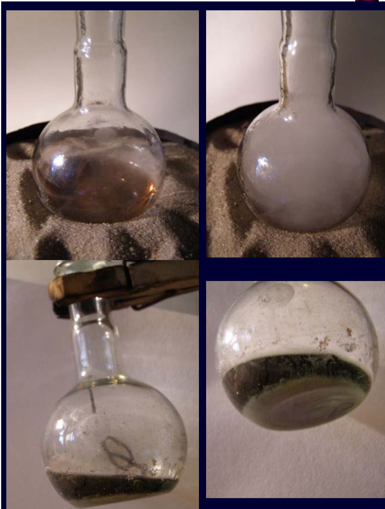
Реакция меди с концентрированной серной кислотой с образованием \text{Cu}_2\text{SO}_4
