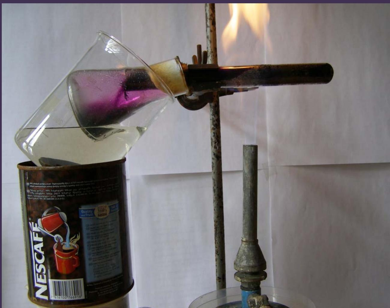
Пробирку необходимо нагревать сильно и по всей длине, иначе в холодных местах будут конденсироваться кристаллы иода. Когда выделение паров почти прекратится, пробирку частично высовывают из приемника и нагревают ее верхнюю часть, где возле горлышка осел иод.
