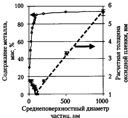
Рис. 1.7. Экспериментально определенное содержание металла в нанопорошках алюминия и расчетные значения толщины оксидных пленок на частицах в зависимости от их диаметра
