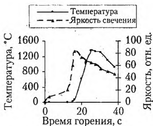
Рис. 4.55. Термограмма горения порошка титана ПТМ m = 2,4 г
