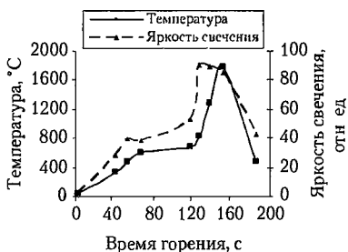
Рис. 4.50. Термограммы горения порошка алюминия марки ПАП-2 а — m = 0,66 г, б — m = 2,7 г
