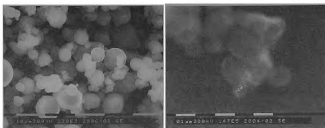
а б Рис. 3.4. Фотографии порошков алюминия марки АСД-4 (а, \times 2300 ) и ALEX (б, \times 147\,000 )
