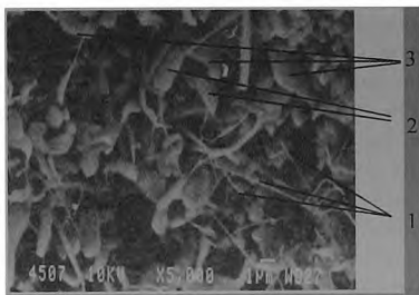
Рис. 4.3. Фотография прекурсора, полученного сжиганием в воздухе смеси 70 % \gamma\text{-Al}_2\text{O}_3 – 30 % НП Al в свободнасыпанном состоянии: 1 – игловидные кристаллы AlN, 2 – «були» оксида алюминия, 3 – плоские шестиугольные кристаллы \alpha\text{-Al}_2\text{O}_3 ( \times 5000 )
