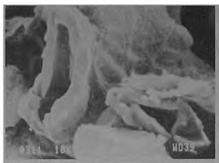
Рис. 4.54. Фотография продуктов сгорания грубодисперсного порошка циркония в воздухе ( \times 3000 )
