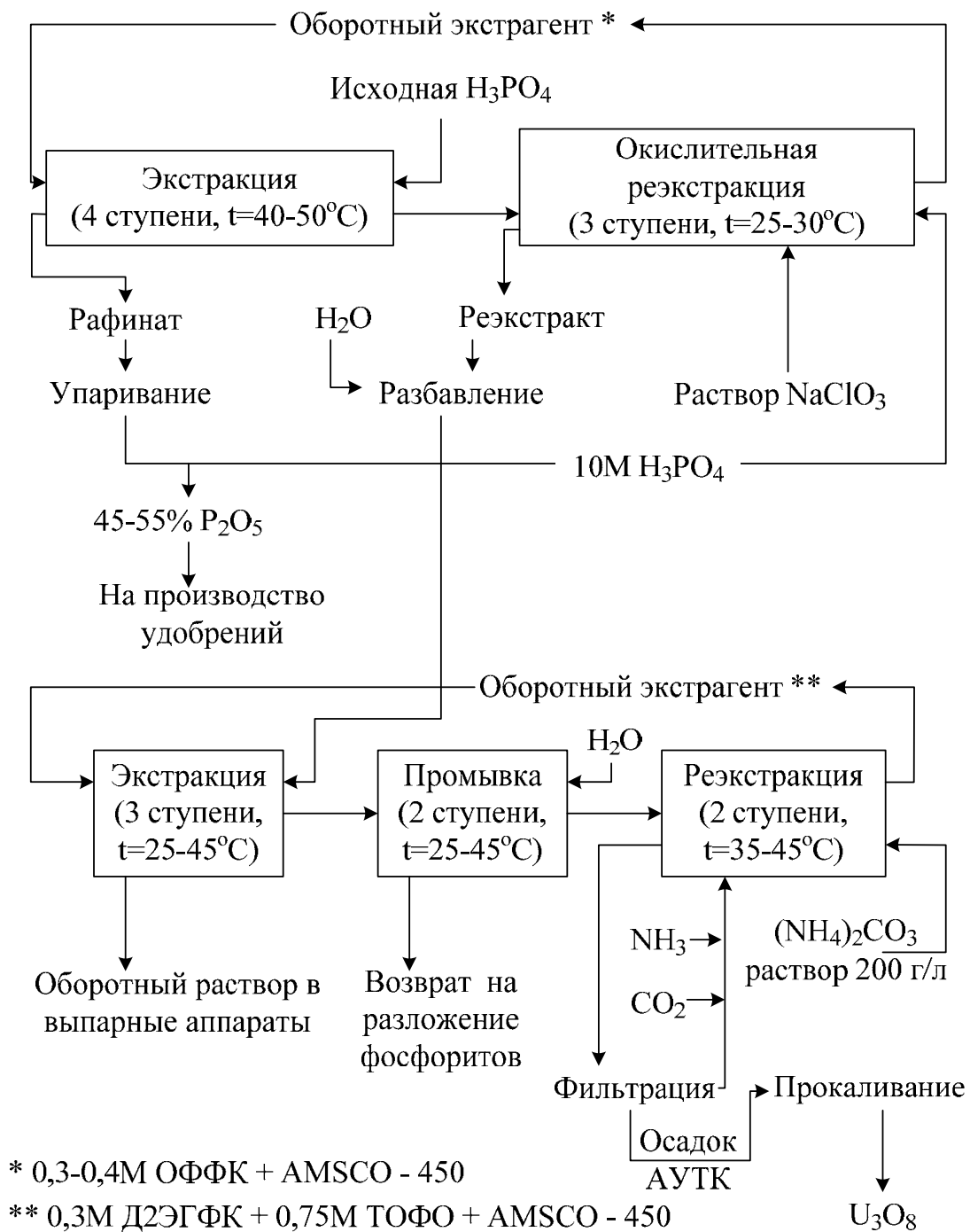
Рис. 7.35. Технологическая схема извлечения урана из фосфорной кислоты с использованием смеси МОФФК и ДОФФК.
