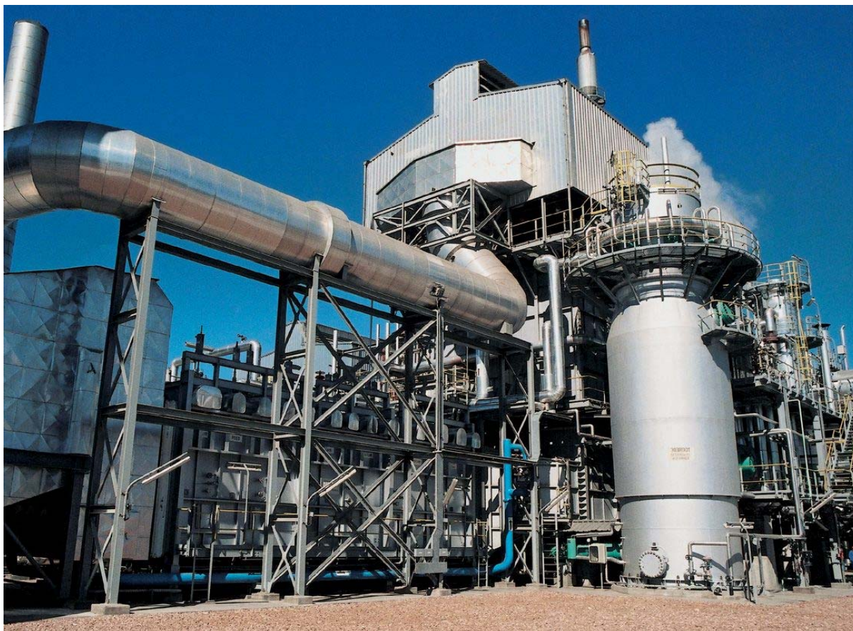
Первичный и вторичный риформинг на установке компании AFC в Египте
