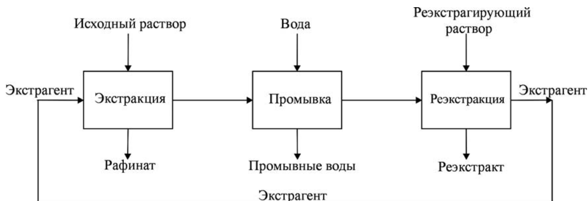
Рис 5.15. Общая схема экстракционного концентрирования металлов
