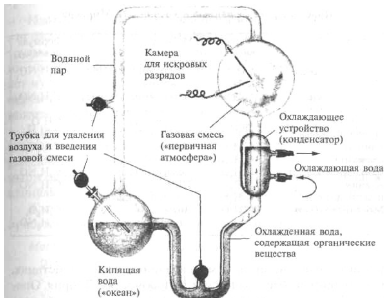
Рис. 3.1. Прибор, использованный Миллером для воспроизведения условий, существовавших на первобытной Земле (из кн.: Raven P. H., Johnson G. B. Biology. 6th edition. N.Y., 2002 [Кемп П., Арме К. Введение в биологию / Пер. с англ. Л. Александрова и др. / Под ред. Ю. Полянского. М.: Мир, 1988. С. 339]
